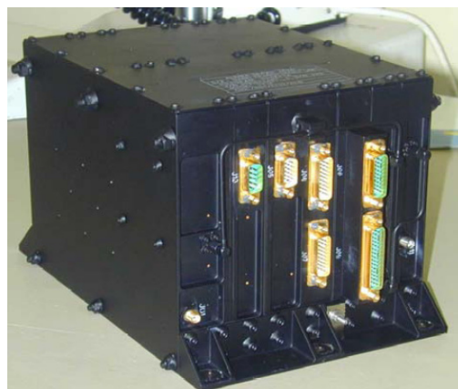
Abbildung 75: Beispiel-Transponder (nur S-Band Uplink und X-Band downlink: Gewicht und Volumenreduktion)
