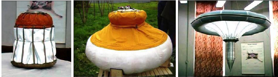
Abbildung 90: MetNet Lander in unterschiedlichen Phasen
