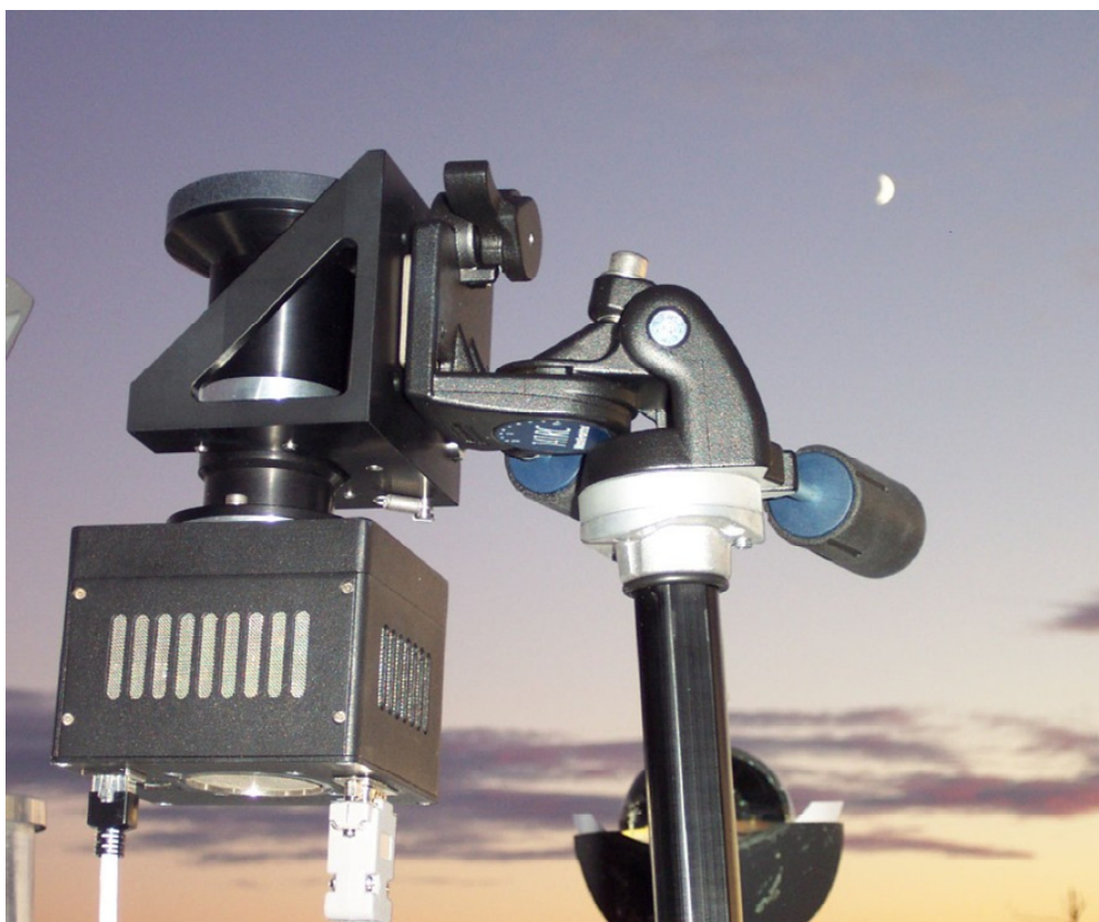
Abbildung 22: SPOSH-VIS Breadboard im Einsatz zur Beobachtung von Meteoroidenschauern (DLR-PF, TUB, DJO)
